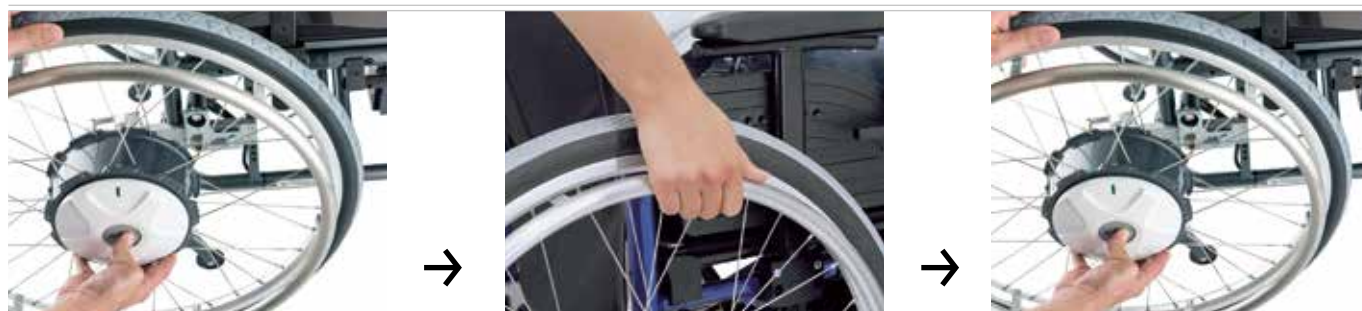
Débrayer la motorisation e-fix...
