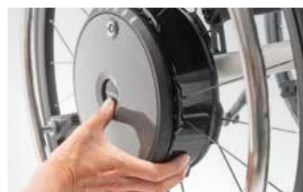
Un bouton d'axe à démontage rapide permet de monter et de démonter les roues e-motion en un tour de main.
